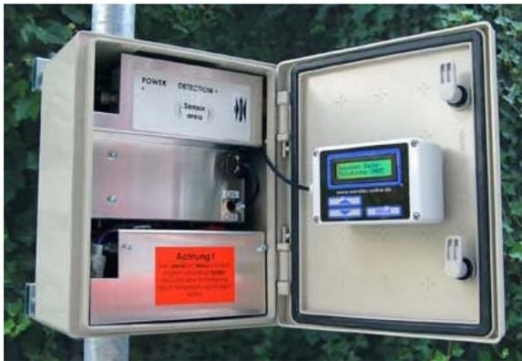
Figura 4.1 – Strumentazione radar Wavetech
